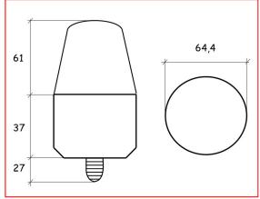
Lampada stroboscopica a risparmio energetico Saving Energy stroboscopic lamp Attacco E27 E27 socket
